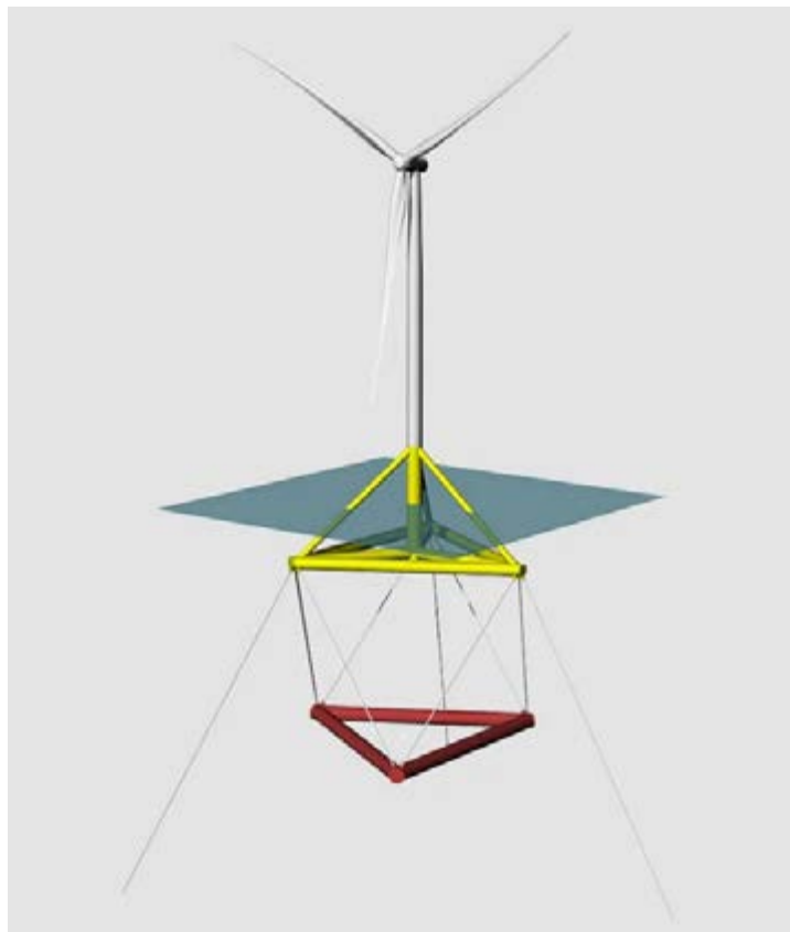
Figur 3.7 Flytende vindkraftturbin av typen Tetraspar er under utprøving, se [3.10].
